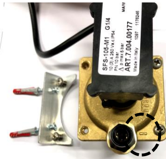
Fig.4-5 – IT- Avvitare la staffa (D) al differenziale di pressione (F) nel lato specularmente opposto a quello con il segno “-“ (cerchiato). EN- Screw the metal bracket (D) to the differential of pressure (F) in the symmetrically opposite side of the one with the “-“ sign (circled). FR- Visser le support (D) sur le différentiel de pression (F) du côté opposé à celui portant le signe “-“ (entouré). ES- Enroscar el soporte metálico (D) en el presostato diferencial (F), en el lado simétricamente opuesto a aquel con el marcador “-“ (señalado en la imagen).
