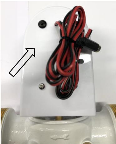
Fig.7 – IT- Rimuovere il rivetto posto nel retro del carter di copertura della testata elettronica. EN- Remove the rivet on the backside of the electronic head cover. FR- Retirez le rivet situé à l'arrière du couvercle de la tête électronique. ES- Quitar el remache que se encuentra en la parte trasera de la la unidad de control electrónico.
