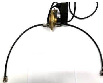
Fig.6 – IT- Tagliare in due parti uguali il tubo nero (G) ed inserirli ognuno negli attacchi rapidi precedentemente avvitati al differenziale di pressione (Fig.3) ed agganciare alle estremità gli attacchi rapidi (C) che andranno collegati nella tubazione in ingresso ed in uscita del filtro. ATTENZIONE: Il segno “+” stampato in rilievo sul differenziale di pressione indica la corrispondenza dell’ingresso dell’acqua; viceversa, il segno “-“ stampato in rilievo sul differenziale di pressione indica la corrispondenza dell’uscita dell’acqua. EN- Cut into two equal parts the black tube (G). Insert each part into the rapid connections previously screwed to the differential of pressure (Fig.3) and connect the rapid connections (C) to the opposite ends; the rapid connections (C) will be connected to the inlet and the outlet of the filter. ATTENTION: The “+” sign stamped on the differential of pressure indicates the side of the water inlet connection; conversely, the “-“ sign indicates the side of the water outlet connection. FR- Couper le tube noir (G) en deux parties égales et les insérer dans les raccords rapides précédemment vissés au différentiel de pression (Fig.3) et accrochez les raccords rapides (C) aux extrémités qui seront connectées à l’entrée et à la sortie du filtre. ATTENTION: Le signe “+” imprimé en relief sur le différentiel de pression indique la correspondance de l’entrée d’eau; inversement, le signe “-“ imprimé en relief sur le différentiel de pression indique la correspondance de la sortie d’eau. ES- Cortar en dos partes iguales la manguera (G) e insertarlas en las conexiones rápidas anteriormente enroscadas en el presostato (Fig.3) y engancharlas en las extremidades. Las conexiones rápidas van a ir conectadas a la tubería a la entrada y salida del filtro. ATENCIÓN: la marca “+” impresa en el presostato diferencial indica el lado de entrada del agua; viceversa, la marca “-“ impresa en el presostato diferencial indica el lado de salida del agua.
